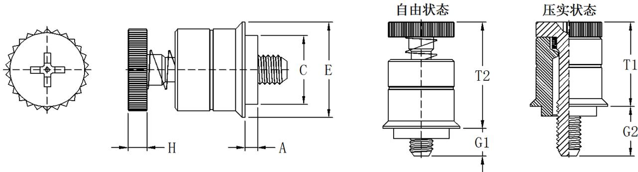
螺纹等级：外螺纹，公制6g、英制2A
